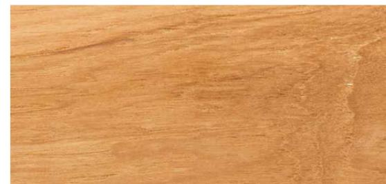
Teakholz ist sehr robust, witterungsbeständig und hart. Im Teak eingelagerte Öle schützen das Holz und sorgen für eine sehr lange Lebensdauer. Für die Reinigung und Pflege empfehlen wir den STERN Teak Reiniger und den STERN Teak Protektor. Alle verwendeten Hölzer unserer Teakmöbel werden mit einer FLEGT-Genehmigung eingeführt.
